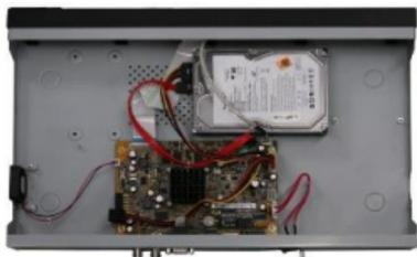
Figure 5-11 Fixação do disco rígido
