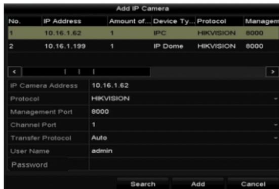
Figure 5-23 Adicionar uma câmera IP
