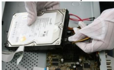
Figure 5-10 Conecte o cabo de alimentação
